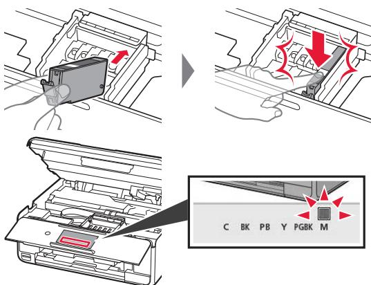
Se il colore non viene visualizzato sullo schermo anche se il serbatoio d'inchiostro è stato installato, il colore del serbatoio d'inchiostro potrebbe non essere corretto oppure potrebbe essere stato installato un serbatoio d'inchiostro che non è supportato da questa stampante, come un serbatoio con un numero di modello diverso. Installare un serbatoio d'inchiostro per il colore corretto o utilizzare il serbatoio d'inchiostro fornito per l'impostazione.
