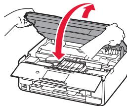
Hvis det vises en feilmelding på skjermen, kontrollerer du at blekktankene er riktig installert.
