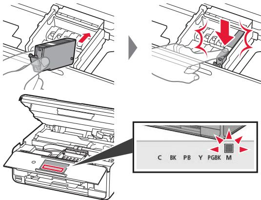
Wenn die Farbe nicht auf dem Bildschirm angezeigt wird, obwohl Sie den Tintenbehälter eingesetzt haben, ist die Farbe des Tintenbehälters möglicherweise falsch oder Sie haben beispielsweise einen Tintenbehälter mit einer anderen Modellnummer eingesetzt, der von diesem Drucker nicht unterstützt wird. Setzen Sie entweder einen Tintenbehälter der richtigen Farbe ein oder verwenden Sie den im Lieferumfang enthaltenen Tintenbehälter für die Einrichtung.
