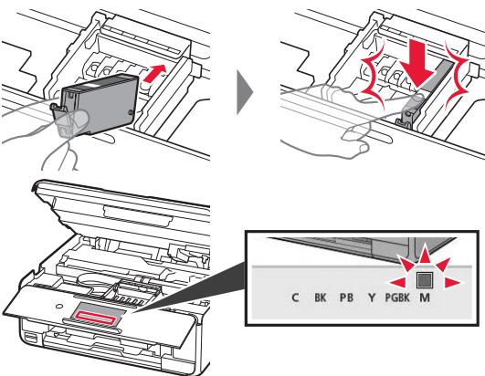
Als de kleur niet op het scherm wordt weergegeven, ook al hebt u de inkttank geplaatst, is de kleur van de inkttank mogelijk onjuist of hebt u mogelijk een inkttank met een ander modelnummer geïnstalleerd die niet wordt ondersteund door deze printer. Plaats een inkttank voor de juiste kleur of gebruik de bijgeleverde inkttank voor de installatie.
