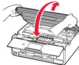
Als er een foutbericht op het scherm wordt weergegeven, controleert u of de inkttanks correct zijn geïnstalleerd.
