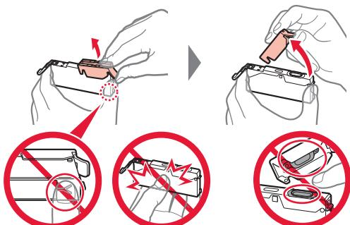
No empuje los lados del depósito de tinta si el orificio de aire en forma de Y está bloqueado.
