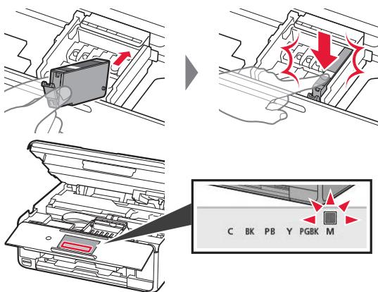
Se a cor não for exibida na tela mesmo que você tenha instalado o cartucho de tinta, a cor do cartucho de tinta pode estar errada ou você pode ter instalado um cartucho de tinta que não é suportado por esta impressora, como com um número do modelo diferente. Instale um cartucho de tinta para a cor correta ou use o cartucho de tinta fornecido para configuração.
