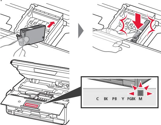
Hvis farven ikke vises på skærmen, selvom du har installeret blækbeholderen, er farven i blækbeholderen muligvis forkert, eller du har muligvis installeret en blækbeholder, der ikke understøttes af denne printer, f.eks. en blækbeholder med en andet modelnummer. Du skal enten installere en blækbeholder med den korrekte farve eller bruge den medfølgende blækbeholder til konfigurationen.
