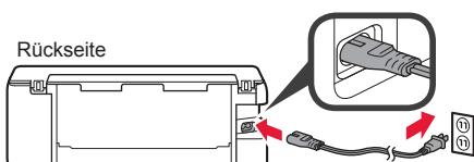
Schließen Sie außer dem Netzkabel noch keine Kabel an.
