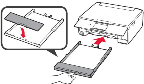
Följande bild visar läget efter att kassetten satts in.
