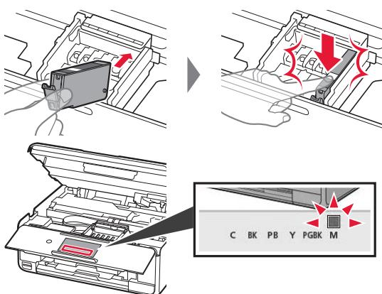
Hvis fargen ikke vises på skjermen, selv om du har installert blekktanken, kan det være at fargen på blekktanken er feil eller at du har installert en blekktank som ikke støttes av skriven (f.eks. en blekktank med annet modellnummer). Installer en blekktank for riktig farge, eller bruk den medfølgende blekktanken for oppsett.
