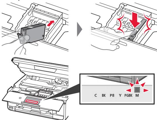
Si no se muestra el color en pantalla a pesar de haber instalado el depósito de tinta, es posible que el color del depósito de tinta no sea correcto o que haya instalado un depósito de tinta, por ejemplo, con un número de modelo distinto que no sea compatible con esta impresora. Instale un depósito de tinta para el color correcto o utilice el depósito de tinta proporcionado para su instalación.
