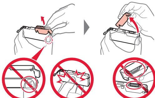
Tryck inte på båda sidor av bläckbehållaren med det Y-formade luftihålet blockerat.
