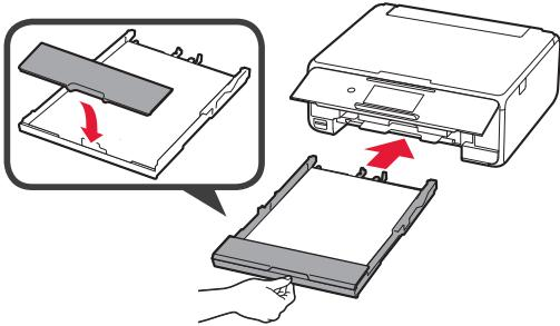
Στο ακόλουθο σχήμα εμφανίζεται η κατάσταση, αφού τοποθετηθεί η κασέτα.
