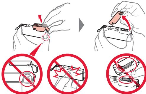
Üben Sie keinen Druck auf die Seiten des Tintenbehälters aus, wenn das Y-förmige Loch blockiert ist.
