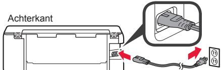
Sluit nog geen kabels aan, behalve het netsnoer.
