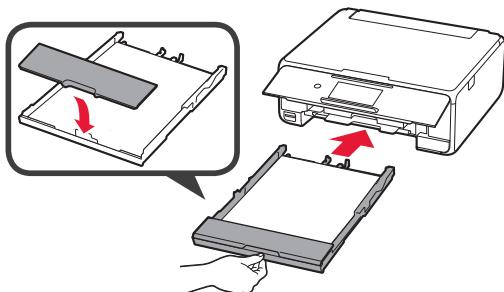
Den følgende figuren viser tilstanden etter at kassetten er satt i.
