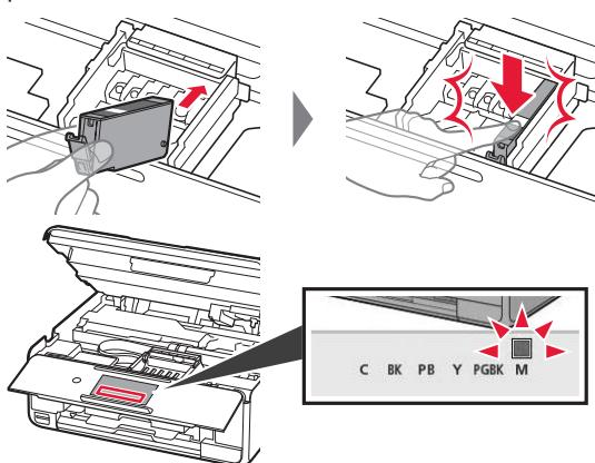
Om färgen inte visas på skärmen sedan du installerat bläckbehållaren kanske bläckbehållarens färg är fel eller så kan du ha installerat en bläckbehållare med ett annat modellnummer som inte stöds av skrivaren. Antingen installerar du en bläckbehållare med rätt färg, eller så använder du den tillhandahållna bläckbehållaren för konfigurationen.
