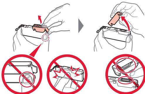
Non premere i due lati del serbatoio d'inchiostro quando il foro dell'aria a forma di Y è bloccato.
