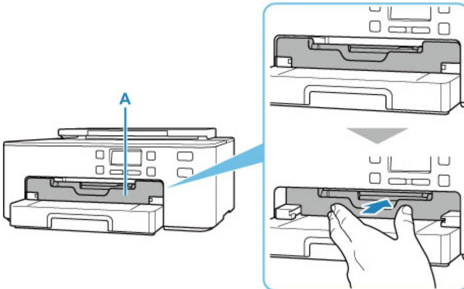
3. Coloque el disco imprimible en la bandeja multiusos.
