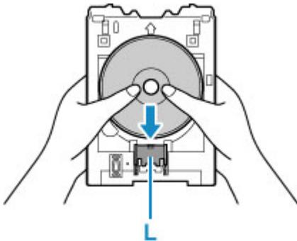
2. Mientras presiona el bloqueo con el disco imprimible, introduzca la parte superior del disco imprimible en las rendijas (M).
