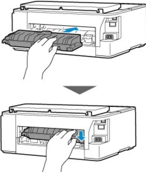
5. Coloque la cubierta trasera.
