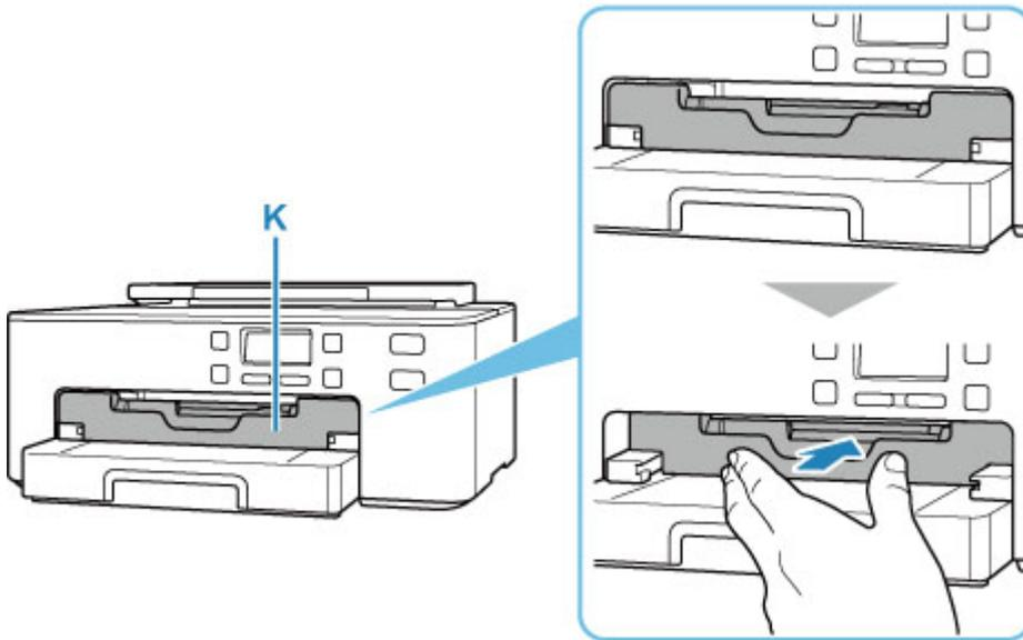
12. Coloque el disco imprimible en la bandeja multiusos.
