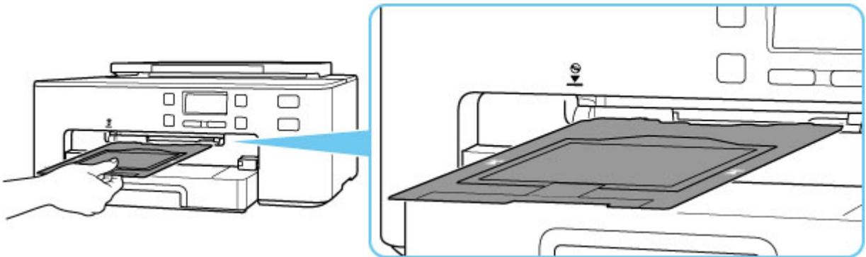
5. Introduzca la bandeja multiusos en dirección horizontal hasta que la flecha (▼) de la guía de la bandeja multiusos esté aproximadamente alineada con la flecha (▲) de la bandeja multiusos.
