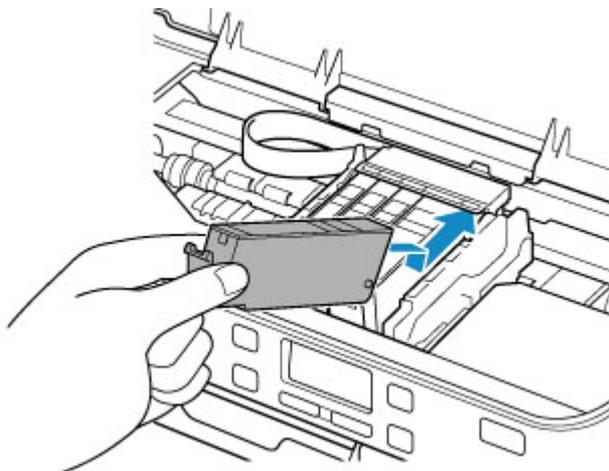
8. Presione en la parte superior del depósito de tinta hasta que el depósito de tinta encaje firmemente en su posición.
