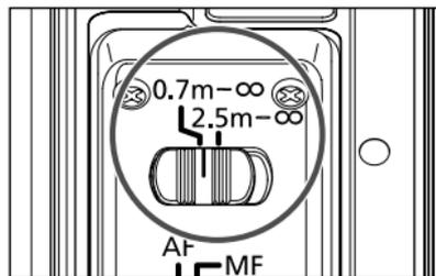
0.7m-∞または2.5m-∞の撮影距離範囲を、スイッチで選べます。撮影距離に応じた設定にすることで、AF作動時間が短くなります。
