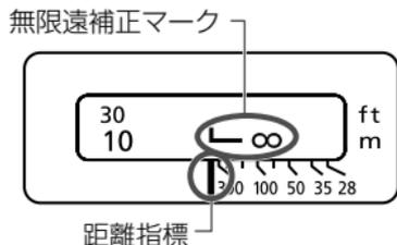
温度変化によるピント移動を補正するため、無限遠 (∞) 位置に余裕を持たせてあります。常温の無限遠位置は、Lマークの縦線と距離指標が合うところです。
