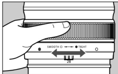
ズームリングの操作感（作動重さ）は、任意に調整することができます。調整は、フォーカスリングを保持したまま、調整リングを回して行います。
