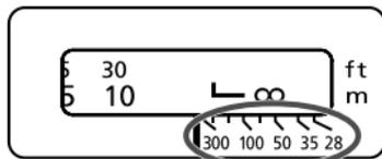
赤外指標は、白黒赤外フィルム使用時のピントを補正するためのマークです。MFでのピント調整後に、距離目盛を赤外指標の位置までずらし撮影します。
