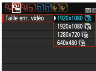
Les options de menu [ 2 : Taille enr. vidéo ] vous permettent de sélectionner la taille d'image de la vidéo [\*\*\*\*x\*\*\*\*] et la cadence d'enregistrement des images [ ] (images enregistrées par seconde). L'élément (cadence d'enregistrement des images) change automatiquement selon le réglage [ 2 : Système vidéo ].
