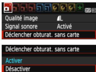
Dans l'onglet [📷 1], sélectionnez [Déclencher obturat. sans carte], puis appuyez sur <SET>. Sélectionnez [Désactiver], puis appuyez sur <SET>. Si aucune carte n'est insérée dans l'appareil photo et que vous enfoncez le déclencheur, « Card » s'affiche dans le viseur et l'obturateur ne peut pas être déclenché.
