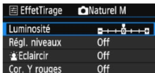
À l'étape 4 de la page 244, sélectionnez un effet d'impression. Lorsque l'icône <☰> s'illumine à côté de <DISP>, vous pouvez appuyer sur la touche <DISP>. Vous pouvez ensuite ajuster l'effet d'impression. Les éléments ajustables ou affichables dépendent de la sélection faite à l'étape 4.
