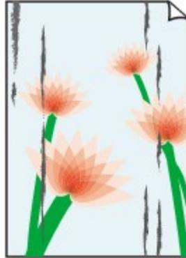
Die Kanten des Papiers sind verschmutzt    Bedruckte Oberfläche ist verschmutzt
