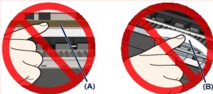
Wenn Sie diese Teile mit dem Papier oder den Händen berühren und Kratzer oder Flecken darauf hinterlassen, kann das Gerät beschädigt werden.
