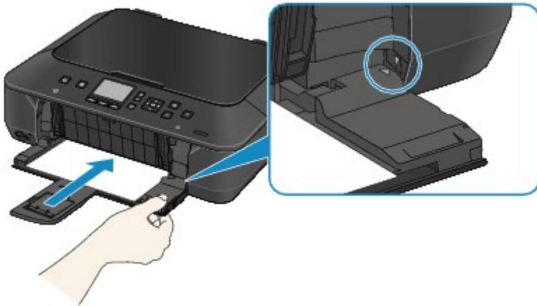
Öffnen Sie das Papierausgabefach, und drücken Sie dann die Taste **OK** am Gerät.
