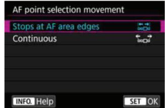
مع ضبط [AI Servo AF] (⊖), [AF4 : Initial AF pt] على [Initial AF pt selected] (⊖), سيعمل هذا الإعداد المذكور أعلاه أيضاً عند تحديد نقطة ضبط البؤرة المبدئية لضبط البؤرة تلقائياً باستخدام AI Servo.
