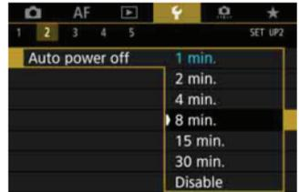
حتى في حالة الضبط على [Disable] (تعطيل)، سيتم إيقاف تشغيل شاشة LCD تلقائيًا بعد ٣٠ دقيقة لتوفير الطاقة. (لا يتم إيقاف تشغيل طاقة الكاميرا).
