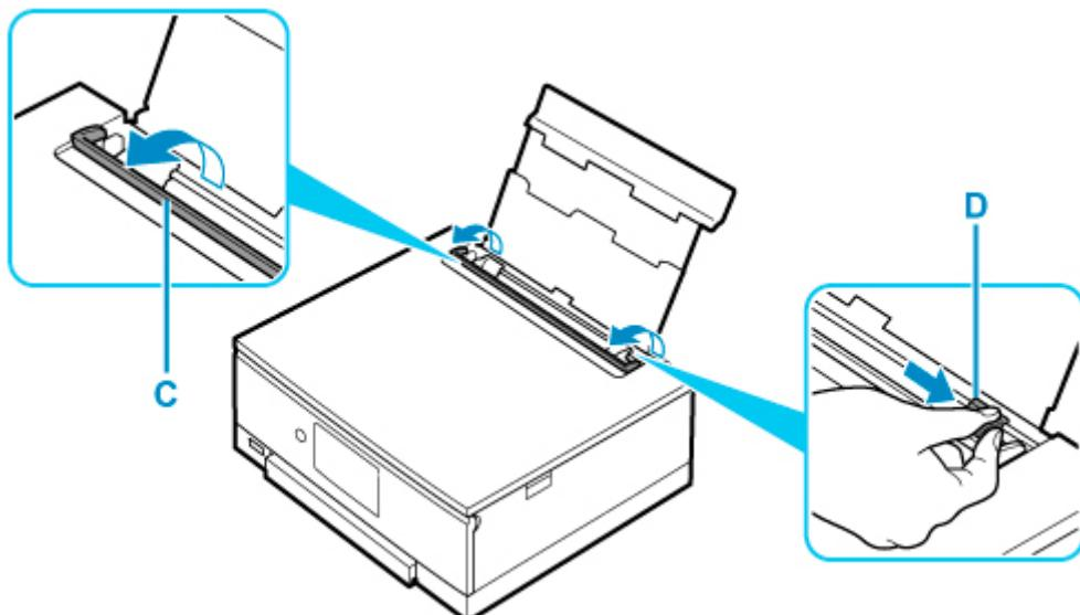
4. 印刷したい面を表にして、写真用紙を縦にセットする
