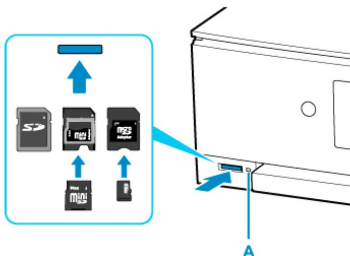
以下のメモリーカードはカードアダプターに取り付けてから、カードスロットにセットしてください。
