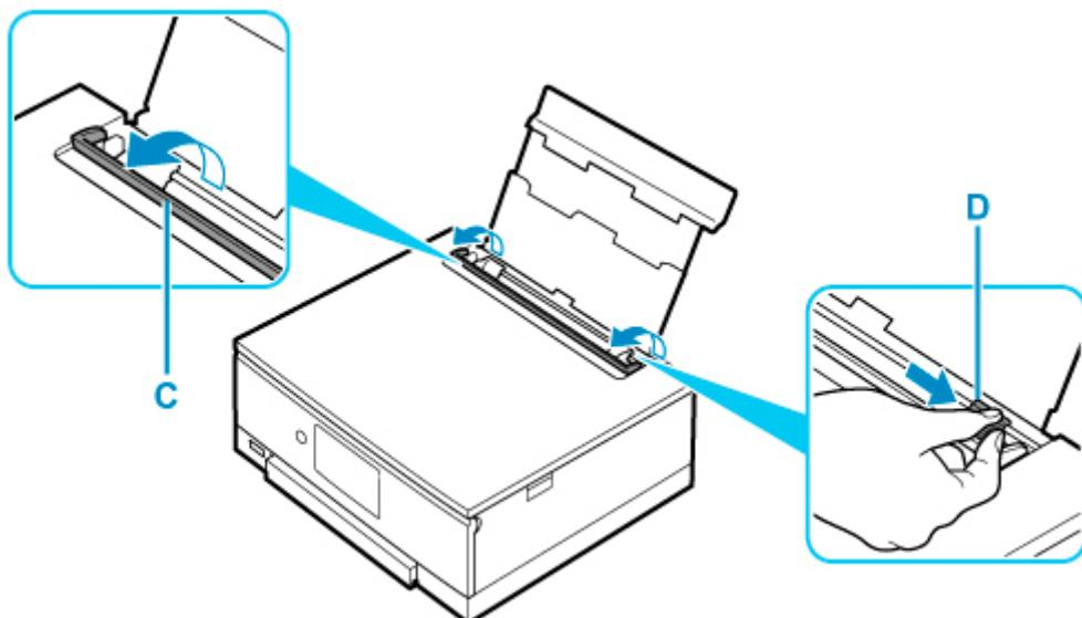
4. 印刷したい面を表にし、写真用紙を縦にセットする
