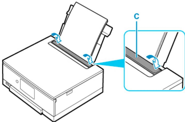
給紙口カバーを閉じると、タッチスクリーンに後トレイの用紙の設定を確認する画面が表示されます。
