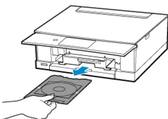
17. ストッパー (M) を押し下げ、プリンタブルディスクを多目的トレイのスリット (N) から外して、取り外す
