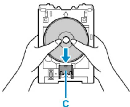
2. プリンタブルディスクでストッパーを押し下げ、プリンタブルディスクの上部を多目的トレイのスリット（D）に差し込む
