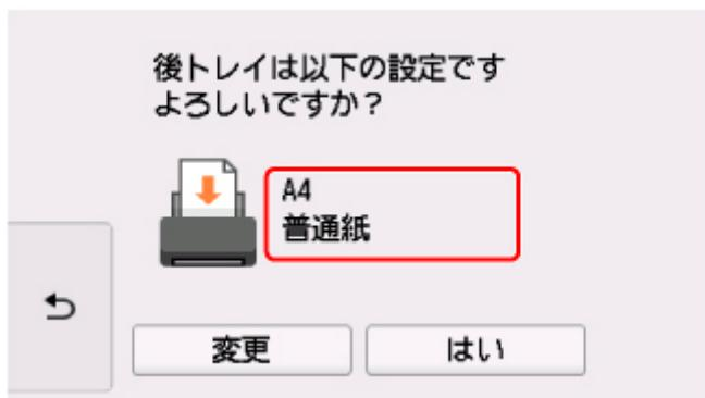
表示された用紙のサイズと種類が、後トレイにセットした用紙と同じであれば、[はい] を選びます。用紙のサイズや種類が異なるときは、[変更] を選んで、セットした用紙に合わせて設定を変更します。
