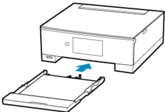
用紙のサイズが自動で検知され、プリンターに設定されます。
