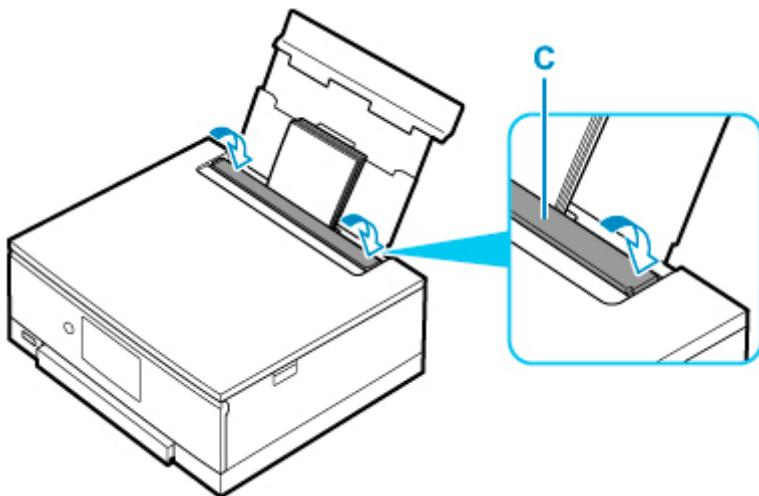
給紙口カバーを閉じると、タッチスクリーンに後トレイの用紙の設定を確認する画面が表示されます。
