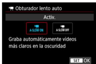
Puede elegir si grabar vídeos más luminosos que cuando se ajusta **[Desac.]** ralentizando automáticamente la velocidad de obturación con poca luz.
