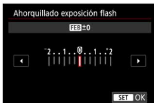
Los flashes Speedlite externos equipados con ahorquillado de la exposición con flash (FEB) pueden cambiar automáticamente la potencia del flash externo, puesto que se realizan tres tomas a la vez.
