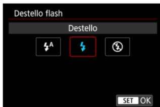
Ajuste [**⚡<sup>A</sup>**] para hacer que el flash dispare automáticamente, en función de las condiciones de disparo.
