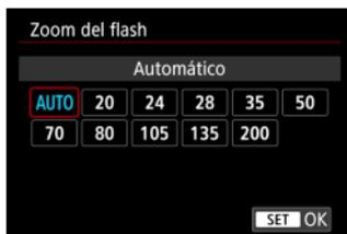
Con los flashes Speedlite que tienen cabeza de flash con zoom se puede ajustar la cobertura del flash.
