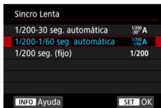
Puede ajustar la velocidad de sincronización del flash para la fotografía con flash en el modo AE con prioridad a la apertura <Av> o en el modo AE programada <P>.
