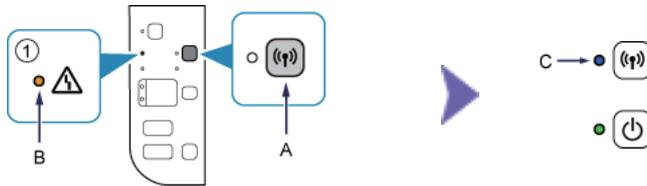
3. Stellen Sie sicher, dass die (blaue) Wi-Fi-Anzeige (C) schnell blinkt und die (grüne) POWER-Anzeige wie in der Abbildung oben rechts gezeigt leuchtet. Drücken und halten Sie dann die Taste am Zugriffspunkt innerhalb von 2 Minuten.
