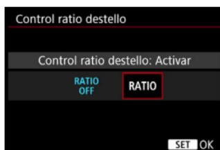
Con un flash macro (MR-14EX II, etc.) compatible con los ajustes de las funciones del flash, puede ajustar el ratio de flash entre tubos del flash o las cabezas de flash A y B, o utilizar el flash inalámbrico con unidades secundarias. Para ver información detallada sobre el control del ratio de flash, consulte las Instrucciones del flash macro.
