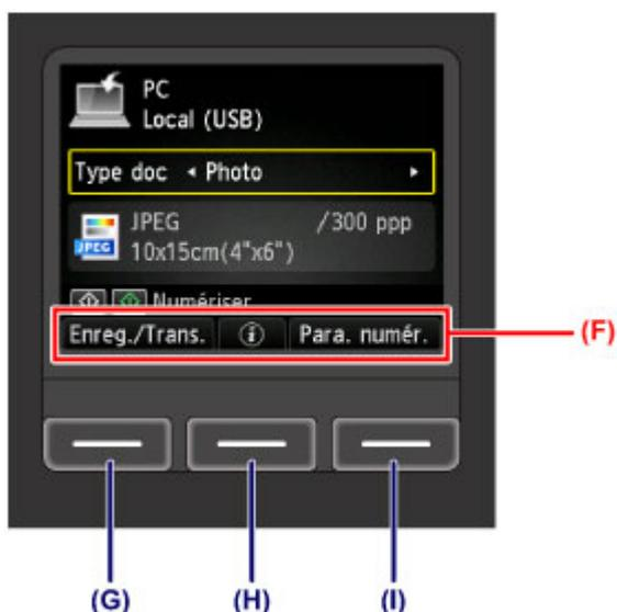
**(G)** Appuyez sur le bouton de **Fonction (Function)** de gauche pour sélectionner **Enreg./ Trans.**. L'écran permettant de sélectionner des emplacements de destination pour enregistrer ou transmettre les données de la photo numérisée s'affiche.
