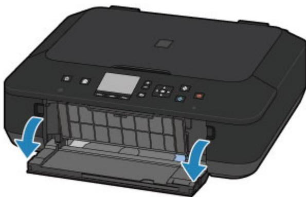
(2) En tenant le taquet de droite du réceptacle avant, tirez sur le chargeur jusqu'à ce qu'il se bloque.
