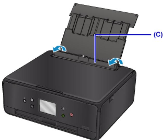
3. 印刷したい面を上にして、用紙を縦にセットする
