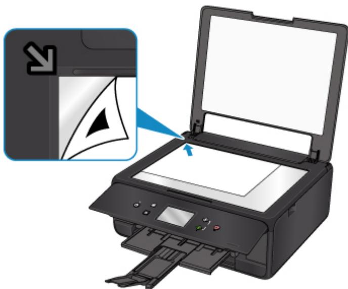
2. 原稿台カバーをゆっくり閉じて、本製品のタッチスクリーンに表示されている [OK] を選ぶ
