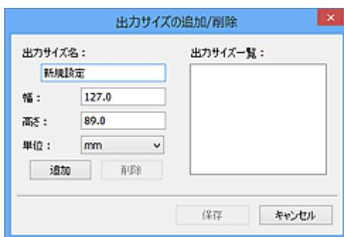
[出力サイズの追加/削除] ダイアログボックスでは、複数の出力サイズを設定し、一度に保存することができます。保存した出力サイズは、[出力サイズを選択する] の選択項目に登録され、既存の項目と同様に選択できます。
