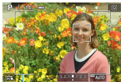
Cornice dell'area AF
