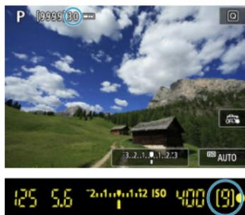
La ráfaga máxima aproximada se muestra como un número u otra indicación en la parte superior de la pantalla de disparo en el disparo con Visión en Directo y en la parte inferior derecha del visor en el disparo con visor.
