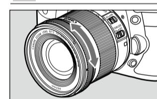
要在自动对焦(AF)模式下进行拍摄,请将对焦模式开关设置为AF。如果仅要使用手动对焦(MF),请将对焦模式开关设为MF,并转动对焦环进行对焦。
