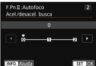
Define a sensibilidade para detetar motivos em movimento cuja velocidade pode mudar temporariamente de forma significativa devido a acelerações ou desacelerações súbitas, etc.
