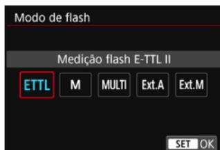
[E-TTL II] é o modo padrão dos Speedlites da série EX para disparo automático com flash.
