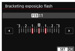
Enquanto a saída de flash é alterada automaticamente, o flash dispara três vezes.
