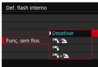
Através da fotografia com flash sem fios (por transmissão ótica), pode utilizar o flash incorporado para controlar Speedlites externos, sem fios.
