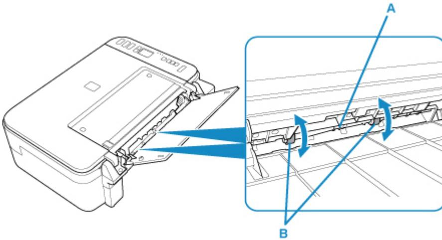
Après avoir nettoyé les rouleaux d'entraînement du papier, mettez la machine sous tension, puis nettoyez à nouveau les rouleaux d'entraînement du papier.
