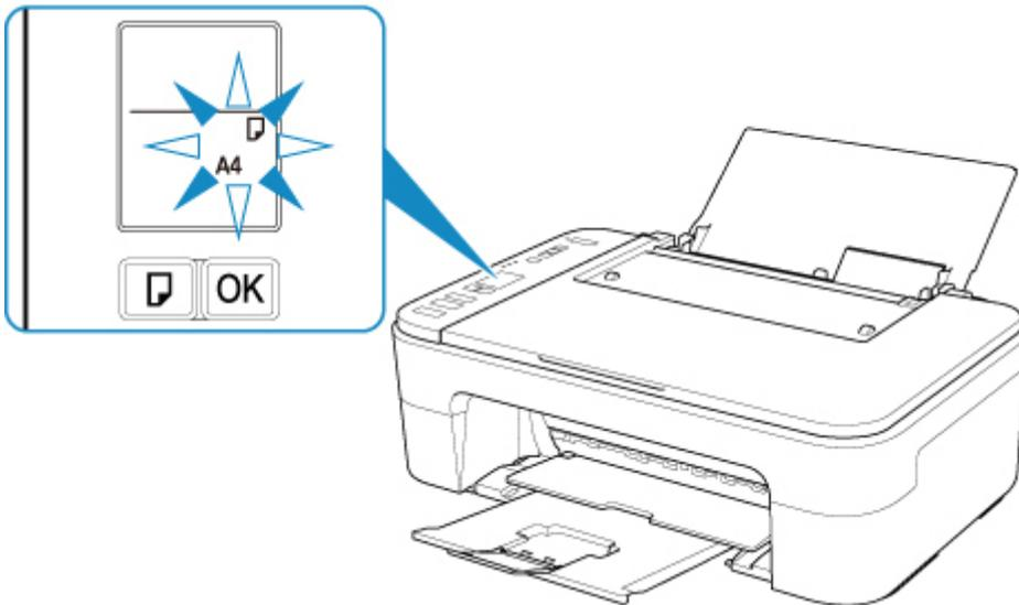
5. Appuyez sur le bouton **Sélectionner le papier (Paper Select)** (E) pour sélectionner un format papier en fonction du papier chargé dans le réceptacle arrière et appuyez sur le bouton **OK** (F).
