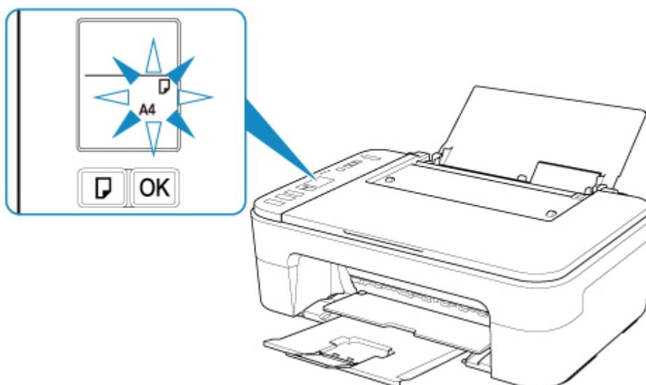
5. Appuyez sur le bouton **Sélectionner le papier (Paper Select)** (H) pour sélectionner un format papier en fonction du papier chargé dans le réceptacle arrière et appuyez sur le bouton **OK** (I).
