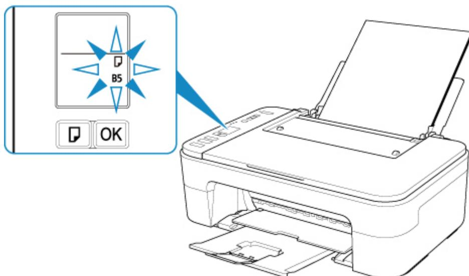
5. Appuyez sur le bouton **Sélectionner le papier (Paper Select)** (E) pour sélectionner un format papier en fonction du papier chargé dans le réceptacle arrière et appuyez sur le bouton **OK** (F).
