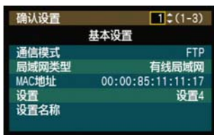
FTP和有线局域网设置的示例
