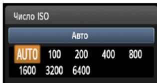
Если для чувствительности ISO задано значение **[AUTO]**, фактически устанавливаемое значение чувствительности ISO отображается при нажатии кнопки спуска затвора наполовину. Как указано ниже, чувствительность ISO автоматически устанавливается в соответствии с режимом съемки.
