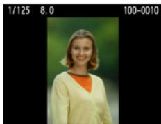
Вертикально ориентированные изображения автоматически поворачиваются для отображения на ЖК-дисплее фотоаппарата и экране персонального компьютера в вертикальной, а не в горизонтальной ориентации. Настройку этой функции можно изменить.
