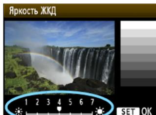
При проверке экспозиции изображения установите яркость ЖК-дисплея на значение 4 и следите, чтобы внешнее освещение не влияло на просматриваемое изображение.
