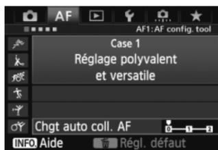
Vous permet de régler la sensibilité changeante des collimateurs autofocus à mesure qu'ils suivent un sujet bougeant beaucoup en haut, en bas, à gauche ou à droite.
