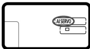
Ce mode autofocus convient pour les sujets en mouvement dont la distance de mise au point change constamment. Pendant que vous maintenez enfoncé le déclencheur à mi-course, la mise au point est effectuée continuellement sur le sujet.
