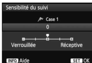
Règle la sensibilité de suivi du sujet dans le mode autofocus AI Servo lorsqu'un obstacle surgit dans les collimateurs autofocus ou lorsque les collimateurs autofocus s'éloignent du sujet.
