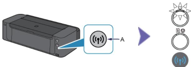
2. 上の図のように、Wi-Fi ランプ(青色)が素早く点滅し、電源ランプが点灯することを確認して、1分30秒以内にアクセスポイントのボタンを長押しします。
