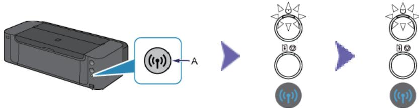
2. 上の中央の図のように、Wi-Fi ランプ (青色) が素早く点滅し、電源ランプが点灯することを確認して、1 分以内にらくらくスタートボタンを長押しします。
