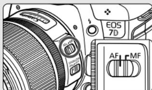
**Positionnez le sélecteur de mode de mise au point de l'objectif sur <AF>.** (p.31)
