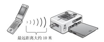
数据传输后,打印机的液晶显示屏上会出现类似下图的画面。蓝牙器 BU-20 也会闪动绿灯。传输完成前请勿断开蓝牙连接。如果连接断开,请在再次打印前,关闭打印机,然后再启动打印机。
