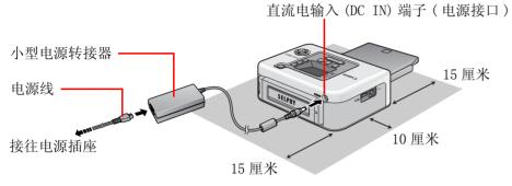
打印机放置的地方,前后应至少留空 15 厘米和两侧至少留空 10 厘米。
