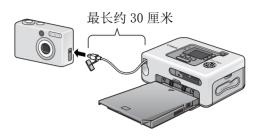
如果可伸缩式 USB 连接线的接口不合相机的端子,请改用随相机附送的 USB 连接线连接相机。
