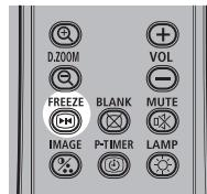
FREEZE ボタンを押すと映像が静止し、画面に次のアイコンが表示されます。
