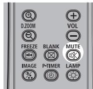
ボタンを押すと音声が消え、下のアイコンが表示されます。
