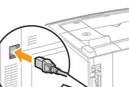
② アース線のキャップを外して、専用のアース線端子に接続する
