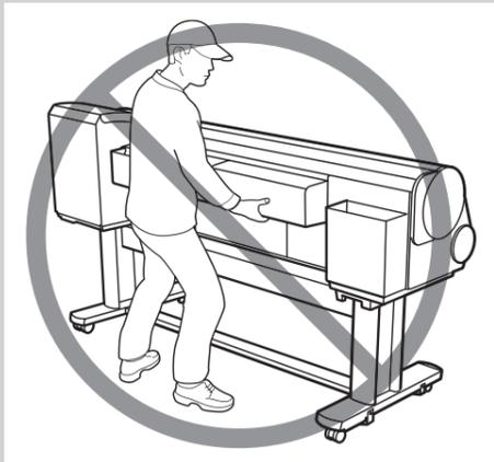
• プリンタの中央部にのみ荷重がかかるような置き方や運搬方法では、プリンタを破損する恐れがあります。
