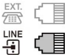
Stellen Sie beim Anschluss des Telefons an das Gerät sicher, dass das Gerät ausgeschaltet ist. Stecken Sie ein Ende des modularen Kabels in die Buchse für externe Geräte in der Nähe der Markierung "EXT." am Gerät. Stecken Sie das andere Ende in die Buchse für Telefonkabel des Telefons.
