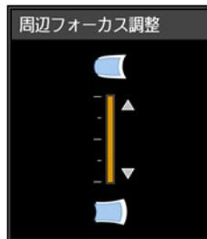
本体の【LENS】ボタンは、押すたびにレンズ関連の画面表示が切り換わります。【LENS】ボタンを2回押すと、周辺フォーカス調整画面が表示されます。
