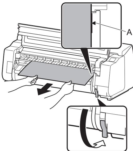
1. ロール紙を図のように引き出し、ロール紙の右端が (A) のラインと平行になるように合わせます。
