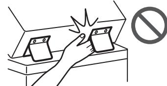
カセットを引き抜いた状態で、本体内部に手を入れない（カセット装着機のみ）
