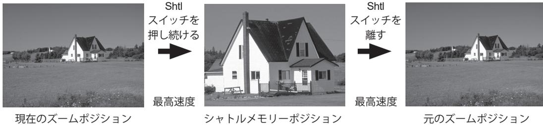
シャトルショット機能を使用するには、シャトル機能をドライブユニットのVTR、RET、AUXスイッチ、もしくはズームデマンドのAUX1、AUX2スイッチに割り付ける必要があります。本取扱説明書では、VTRスイッチにシャトルショット（Shtl）機能を割り付けた場合で説明します。
