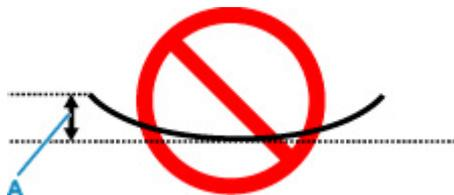
1. 下の図のように、対角線上の端を、反りと逆方向に丸める
