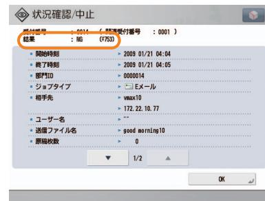
e-マニュアル>トラブルシューティング、スキャンして送信、ファクスに各終了コードの原因と対処方法を掲載していますので、参照の上、必要な処理を行ってください。
