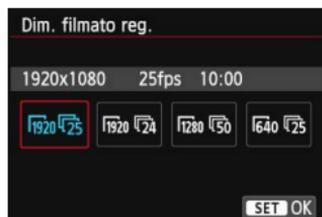
L'opzione di menu [ 2: Dim. filmato reg.] consente di selezionare il formato delle immagini del filmato [\*\*\*\*x\*\*\*\*] e la frequenza immagini [ ] (fotogrammi registrati al secondo). L'icona (frequenza immagini) cambia automaticamente a seconda dell'impostazione [ 2: Sistema video].
