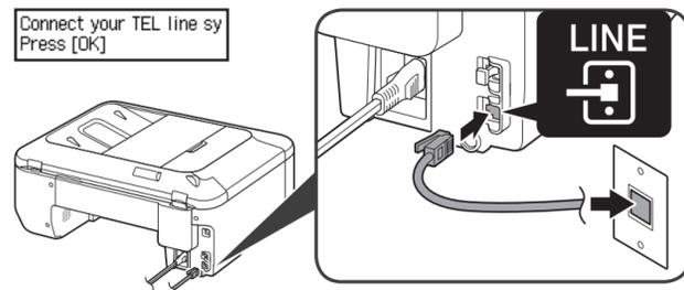
Conecte a máquina com uma tomada de linha telefônica usando o cabo de linha telefônica fornecido e, em seguida, pressione o botão **OK**.
