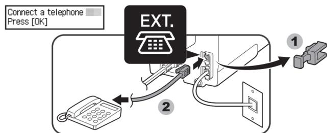
Si desea conectar un teléfono o un contestador, retire la tapa, conecte un teléfono o un contestador automático con un cable de línea telefónica y pulse el botón **OK**.
