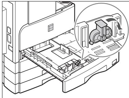
**6** 変更したサイズの用紙をカセットにセットします。
