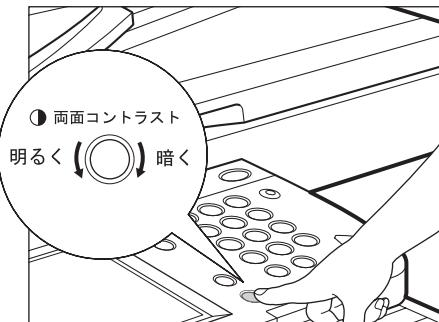
**メモ** 明るくする場合は、ダイヤルを反時計回りに回します。暗くする場合は、ダイヤルを時計回りに回します。
