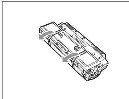
12 拍車カバーのタブを持って、拍車カバーをはずします。
