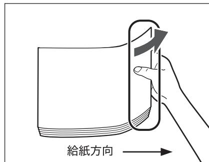
一度コピーした用紙の裏面に手差しコピーするときは、カールをなおしたあと、コピーする面を下向きにして、また、最初のコピーで後に排紙された辺が給紙方向になるように、用紙をセットしてください。
