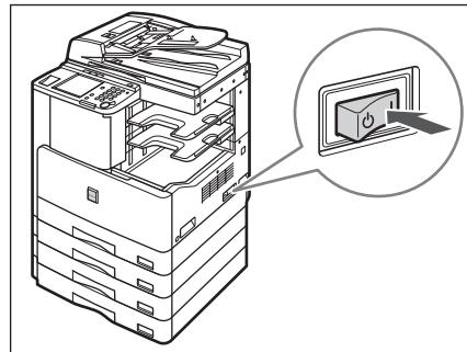
操作パネルの主電源ランプが点灯します。
