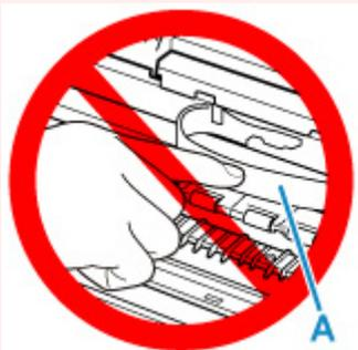
Der Drucker kann beschädigt werden, wenn Sie dieses Teil durch Papier- oder Handberührungen verunreinigen oder zerkratzen.
