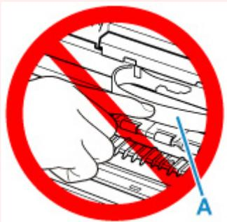
Der Drucker kann beschädigt werden, wenn Sie dieses Teil durch Papier- oder Handberührungen verunreinigen oder zerkratzen.
