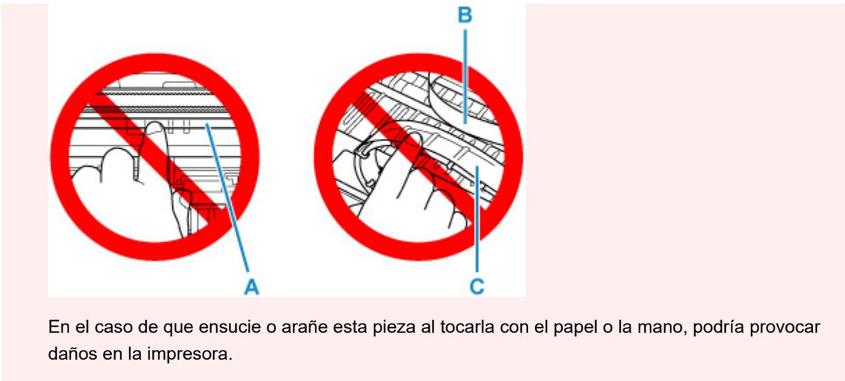
**3. Compruebe si el papel atascado está debajo del soporte del cabezal de impresión.**
