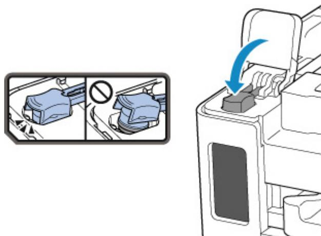
**9.** Cierre la cubierta del depósito de tinta completamente.
