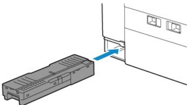
**6. Coloque la tapa de mantenimiento.**
