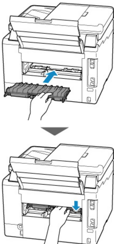
**5. Coloque la cubierta trasera.**
