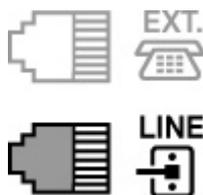
Cuando conecte el teléfono a la impresora, asegúrese de que la impresora esté apagada, conecte un extremo del cable modular a la clavija de dispositivo externo cerca de la marca "EXT." de la impresora y, a continuación, conecte el otro extremo a la clavija de línea telefónica del teléfono.
