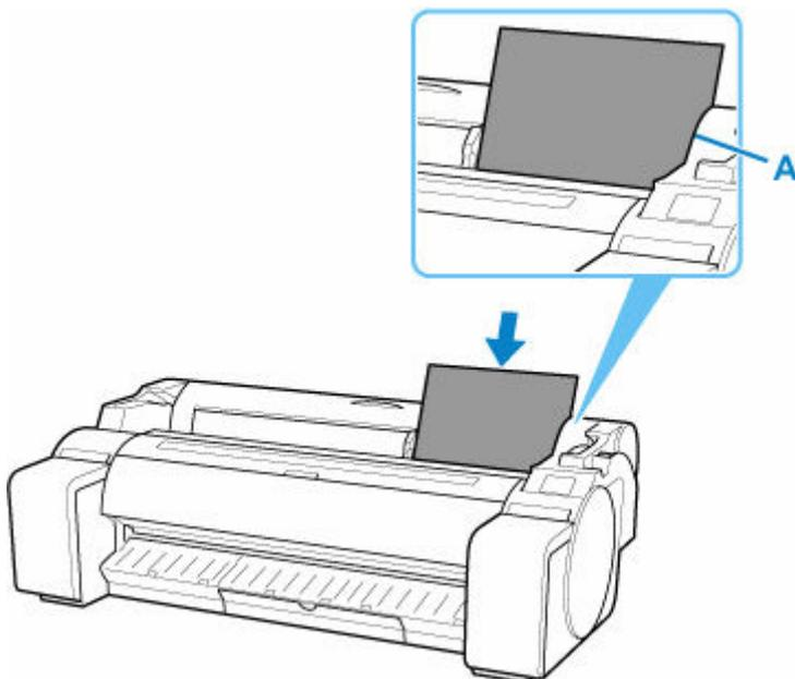
**4. 幅ガイド（A）の位置をセットした用紙のサイズに合わせて微調整する**
