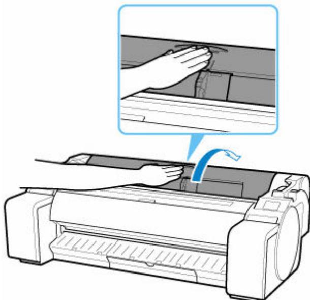
4. A4 サイズの用紙を縦に四つ折りにして給紙口のすきまに差し込み、つまった用紙をプラテン側に押し出します。
