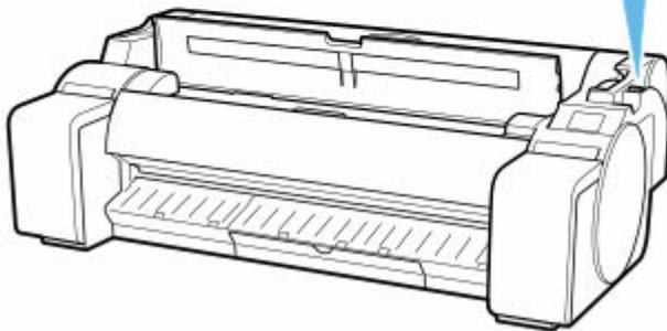
4. 用紙の右端をプリンター本体の右側の紙合わせライン (A) の延長線上に合わせながら、印刷を開始したい任意の位置をプラテンの奥側の溝 (B) に合わせてセットする
