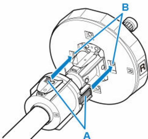
3. 図のように、ロール紙の先端を手前側に向けて、ロール紙の右側からロールホルダーを差し込み、ロール紙が、ロールホルダーのフランジ (A) に隙間なく突き当たるまでしっかりと差し込む
