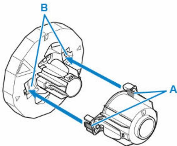
5. 図のように、ホルダーストッパーを左側からロールホルダーに差し込み、図の位置 (B) を持ってホルダーストッパーのフランジ (A) がロール紙に突き当たるまでしっかりと押し込む。ホルダーストッパーのレバー (C) を🔒のほうに回してロックする
