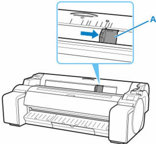
**3. 印刷面を上にし、用紙の右端をロール紙カバーの右側の紙合わせライン（A）に沿わせるようにして、給紙口に用紙を1枚セットする**
