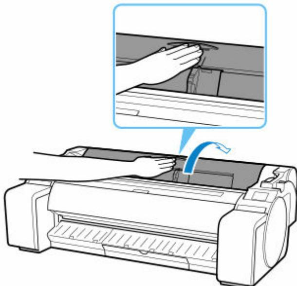
5. 両手でロールホルダーを後方に回してロール紙を巻き取る
