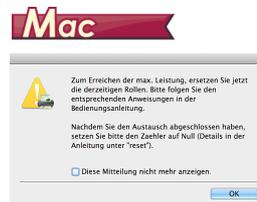
Wenn diese Mitteilung beim Starten angezeigt wird, müssen Sie einen Rollenaustauschsatz kaufen und die abgenutzten Teile durch die Verbrauchsmaterialien im Austauschsatz (Einzugsrolle und Verzögerungsrolle) ersetzen. [Siehe S. 61](#) zum Ersatzrollen-Set. Darüber hinaus muss der im Scanner befindliche Zähler, der die Anzahl der eingezogenen Seiten zählt, zurückgesetzt werden, wenn Sie die Rollen ersetzen. ([Siehe S. 46](#))
