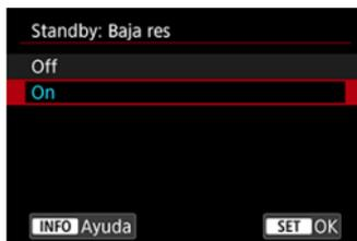
Ajuste en **[On]** para ahorrar energía de la batería y controlar el aumento de temperatura de la cámara durante la espera.
