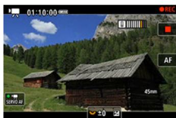
**[PQ]** parpadea en rojo si sigue grabando después de que el indicador haya alcanzado el nivel 9, que se marca en naranja. Un icono que parpadea indica que la cámara se apagará automáticamente en breve.
