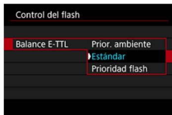
Puede ajustar la apariencia (balance) que prefiere para las fotografías con flash. Este ajuste permite establecer la relación entre la luz ambiental y la potencia de la luz del flash Speedlite.
