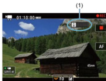
Si la temperatura interna sube, el nivel del indicador se va ampliando hacia la derecha. La rapidez con la que aumente el nivel dependerá de las condiciones de la toma. Los niveles 1–7 se marcan en blanco, pero el color cambia en cuando la temperatura alcanza el nivel 8.
