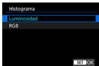
Los histogramas muestran los niveles de señal a través de la gama tonal. Están disponibles la visualización de la luminosidad (para comprobar el nivel de exposición general y la gradación global) y la visualización RGB (para consultar la saturación y la gradación de rojo, verde y azul). Puede cambiar el histograma que se muestra presionando el botón < INFO > cuando se muestre [INFO] abajo a la izquierda de la pantalla [▶]: **Visualiz. info. reproducción**].
