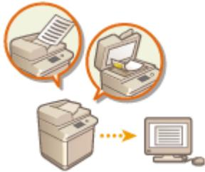
原稿の枚数が多くて一度にフィーダーにセットできない場合でも、数回に分けて原稿を読み込み、1つにまとめて送信／保存することができます。フィーダーから読み込んだ原稿と、原稿台ガラスから読み込んだ原稿をまとめて送信／保存することもできます。
