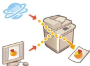
リモート UI を使って、パソコンやネットワーク上に保存されているファイルを、プリンタードライバーを使わずに本機から直接印刷することができます。パソコン上でファイルを開いて印刷する必要がありません。
