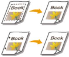
原稿よりも大きい読み取りサイズを指定したときに写り込む原稿の枠線や、厚みのある本を読み込んだときにできる影を消すことができます。原稿のパンチ穴を消すこともできます。
