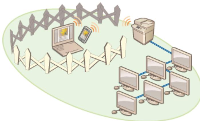
本機およびユーザーズガイドでは、2 系統ネットワークにおいてメインで使用する有線 LAN を「主回線」、サブで使用する無線 LAN または別の有線 LAN を「副回線」と呼びます。
