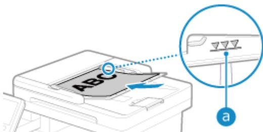
原稿が積載制限マーク（a）を超えないようにセットします。積載制限マーク以上の原稿をセットすると、原稿の搬送不良や紙づまりの原因になります。
