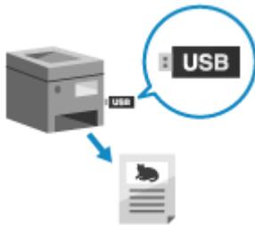
メモリーメディアプリントとは、本機に差し込んだ USB メモリー内の PDF/JPEG/TIFF ファイルを、パソコンやプリンタードライバーを介さずに直接プリントする機能です。JPEG/TIFF の画像ファイルは、操作パネルの画面でプレビュー画像を確認してからプリントすることもできます。ネットワーク接続していないパソコンのファイルや、外部から持ち込んだファイルをプリントするときなどに便利です。
