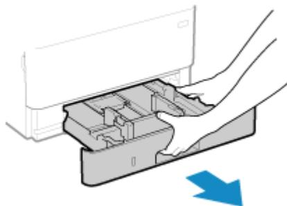
給紙カセットは必ず両手で持ち、静かに引き出します。片手で引き出すと勢いが付いて落下し、破損する恐れがあります。
