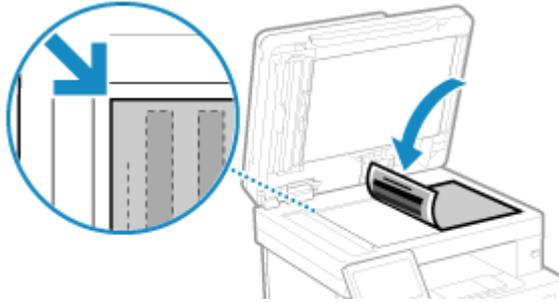
補正画像のプリント面を下にして、黒い細線を左側にしてセットします。
