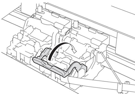
**9** 手順2～8を繰り返して、2個目の「プリントヘッド」をセットします。「上カバー」を閉じます。
