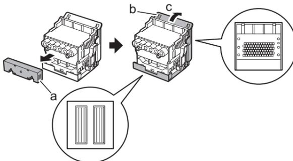
**6** 図のように、インク供給部(a)を手前上側にして、「プリントヘッド」をキャリッジ(b)に差し込みます。保護部品に保護されていた部分がキャリッジ(b)に当たらないように注意しながら、奥までしっかりと押し込みます。
