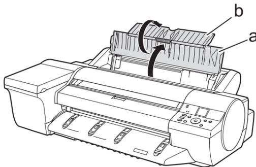
**3** 幅ガイド (a) をスライドし、セットする用紙のサイズの刻印に合わせます。
