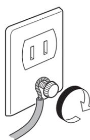
**10** 電源コードをプリンタ背面の「電源コネクタ」に差し込み、反対側をコンセントに差し込みます。
