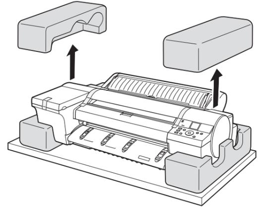
**3** プリンタの左右底面の「運搬用取っ手」(a)を両側から持ち、テーブルなどの水平な場所に置きます。
