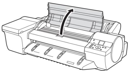
**2** 「プリントヘッド固定レバー」を前側に引いて、最後まで完全に開きます。
