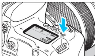
Attivare (☼) o disattivare l'illuminazione del pannello LCD premendo il pulsante <☼>. Durante un'esposizione posa, se si preme a fondo il pulsante di scatto, l'illuminazione del pannello LCD viene disattivata.
