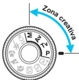
Per ottenere particolari risultati di scatto, nelle modalità della zona creativa è possibile modificare una serie di impostazioni della fotocamera selezionando la velocità dell'otturatore e/o l'apertura, regolando l'esposizione e così via.
