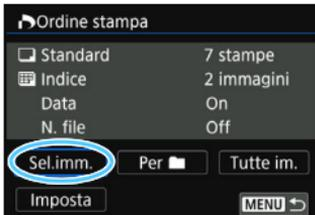
Selezionare e ordinare le immagini una alla volta. Premendo il pulsante  $\langle \text{SEL} \rangle$ , è possibile selezionare le immagini da un display a tre immagini. Per ritornare alla visualizzazione di una sola immagine, premere il pulsante  $\langle \text{Q} \rangle$ . Premere due volte il pulsante  $\langle \text{MENU} \rangle$  per salvare l'ordine di stampa sulla scheda.
