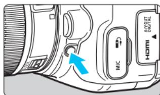
Premere il pulsante di anteprima della profondità di campo per mantenere l'impostazione di apertura corrente dell'obiettivo e controllare la profondità di campo (intervallo di messa a fuoco accettabile).
