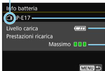
Modello della batteria o tipo di presa domestica utilizzata.
