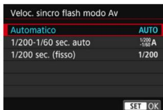
È possibile impostare la velocità di sincronizzazione del flash per le fotografie con flash nella modalità AE priorità diaframma (**Av**).
