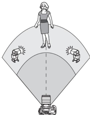
Utile quando è necessaria un'ampia potenza del flash. Tutti le unità secondarie si attivano con la stessa potenza e sono controllate per ottenere un'esposizione standard. Indipendentemente dal gruppo flash (A, B, o C) cui appartengono, le unità secondarie vengono tutte attivate come un unico gruppo.
