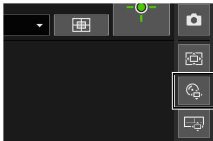
[デジタルPTZ] ボタンがアクティブ（紫）に変わり、コントロール表示部にデジタルPTZパネルが表示されます。
