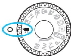
La grabación de vídeo se activa ajustando el dial de modo en
