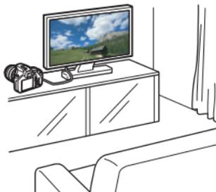
**Para conectar la cámara a un televisor es necesario un cable HDMI (se vende por separado). Además, se necesita un terminal HDMI en un televisor.**
