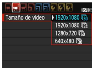
La opción del menú [F2: Tamaño de vídeo] permite seleccionar el tamaño de imagen de vídeo [\*\*\*\*x\*\*\*\*] y la frecuencia de fotogramas [Fps] (fotogramas grabados por segundo). La Fps (frecuencia de fotogramas) cambia automáticamente en función del ajuste de [F2: Sistema vídeo].
