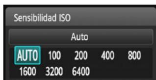
Si la sensibilidad ISO se ajusta en **[AUTO]**, el ajuste de sensibilidad ISO real se mostrará al presionar el disparador hasta la mitad. Como se indica en la página siguiente, la sensibilidad ISO se ajustará automáticamente para adecuarse al modo de disparo.
