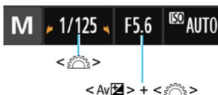
3 **Ajuste la velocidad de obturación y la abertura.**
