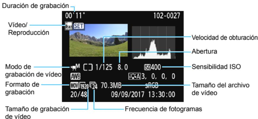
\* Si se utiliza la exposición manual, se mostrará la velocidad de obturación, la apertura y la sensibilidad ISO (si se ajustó manualmente).
