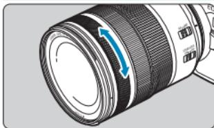
Par défaut, la valeur d'ouverture peut être réglée en tournant la bague de commande des objectifs RF ou des bagues d'adaptation monture tout en enfonçant le déclencheur à mi-course en mode [**Fv**], [**Av**], [**M**], ou [**BULB**]. Sinon, vous pouvez attribuer une fonction différente à la bague de commande en personnalisant les opérations dans [**¶.4 : Personnaliser les molettes**] (p. 555).
