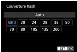
Avec les flashes Speedlite pourvus d'une tête de flash zoom, vous pouvez régler la couverture du flash. En règle générale, réglez cette option sur **[AUTO]** pour que l'appareil photo règle automatiquement la couverture du flash en fonction de la distance focale de l'objectif.
