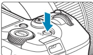
En réglant [**¶6 : Verrouillage multifonction**] et en appuyant sur la touche <LOCK>, vous pouvez éviter la modification des réglages en actionnant accidentellement la molette principale, la molette de contrôle rapide, la barre M-Fn ou la bague de commande ou en touchant par inadvertance l'écran tactile. Appuyez à nouveau sur la touche <LOCK> pour déverrouiller les commandes. Reportez-vous à la page 416 pour en savoir plus sur [**¶6 : Verrouillage multifonction**].
