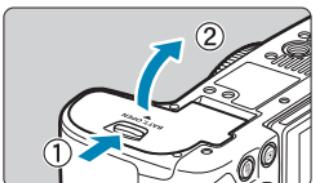
**1 Faites glisser le verrou du couvercle du compartiment de la batterie et ouvrez le couvercle.**
