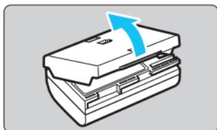
**1** Retirez le couvercle de protection fourni avec la batterie.
