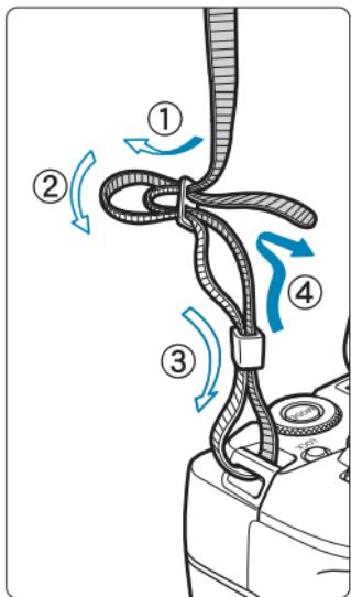
Passez l'extrémité de la courroie à travers l'œillet de support de courroie de l'appareil par le bas. Ensuite, faites-la passer dans la boucle de la courroie de la manière illustrée. Tendez la courroie en tirant dessus et assurez-vous qu'elle est bien fixée.
