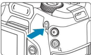
Revient à enfoncer le déclencheur à mi-course dans le mode de prise de vue [Fv], [P], [Tv], [Av], [M] ou [BULB].
