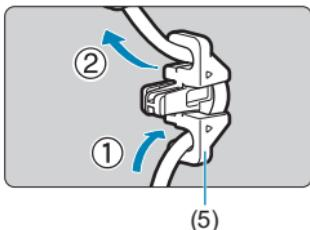
Lorsque vous utilisez un câble d'interface Canon d'origine (vendu séparément), faites passer le câble par le serre-câbles (5) comme illustré avant de fixer le serre-câbles au protecteur de câble.
