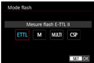
**[Mesure flash E-TTL II]** est le mode standard des flashes Speedlite de la série EL/EX pour la photographie avec flash automatique.
