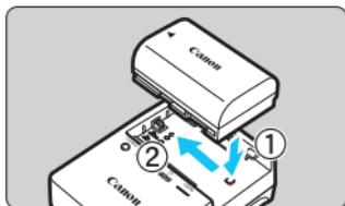
**2** Insérez complètement la batterie dans le chargeur.
