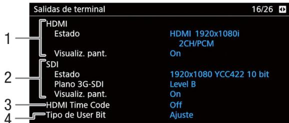
1 Estado del terminal HDMI OUT: señal salida (📖 154), salida de visualizaciones en pantalla (📖 154)
