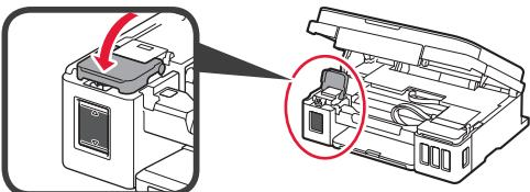
**9** Ulangi langkah 2 sampai 8 untuk menuang semua tinta ke kotak tinta yang sesuai pada sebelah kanan menurut labelnya.
