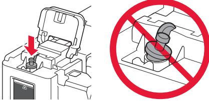
**8** Tutup penutup unit kotak tinta.
